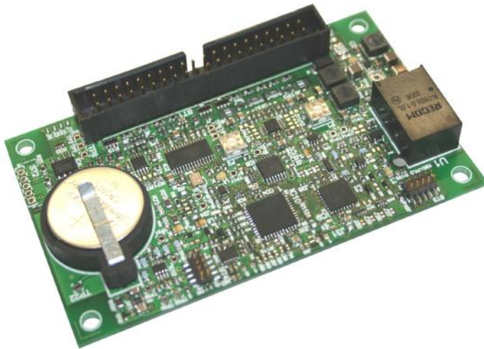
Darstellung mit Optionen Spannungsversorgung mit Weitbereichseingang und Eingangsfilter, regelbare Videoverstärkung und Stiftsteckerwanne
