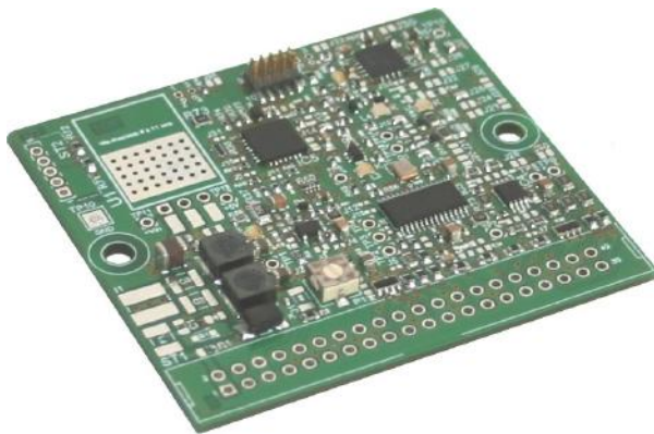
Darstellung Baugruppe mit Option RS232-Schnittstelle mit Treiber und Kontroll-LED
